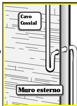
FIGURA 5: Fissaggio del cavo
