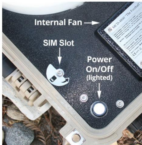
All'interno della custodia c'è un pulsante di accensione illuminato e lo slot della scheda SIM. La ventola interna aiuta a mantenere fresca l'elettronica se la temperatura aumenta. Si consiglia di aprire la custodia per favorire lo sfogo dell'accumulo di calore in eccesso nella stagione calda.
