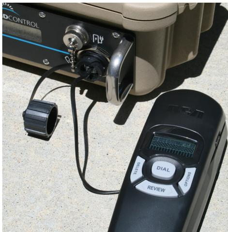
L'MCD-4800 include un telefono analogico a 2 fili (anche un cordless standard funziona). La porta RJ-11 fornisce un segnale di linea standard con associato un numero di telefono satellitare..
