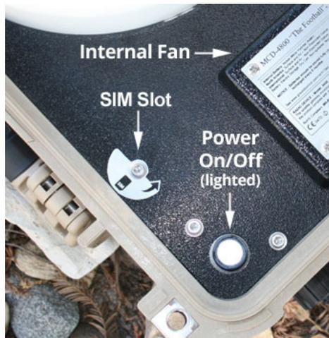
All'interno della custodia c'è un pulsante di accensione illuminato e lo slot della scheda SIM. La ventola interna aiuta a mantenere fresca l'elettronica se la temperatura aumenta. Si consiglia di aprire la custodia per favorire lo sfogo dell'accumulo di calore in eccesso nella stagione calda.
