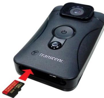
1. Inserire una microSD nell'apposito slot situato nella parte inferiore della camera.
