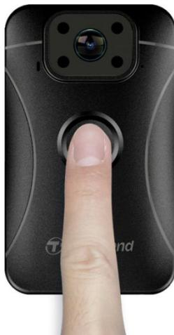
Durante le ore notturne o in condizioni di luce bassa, i LED infrarossi si attiveranno automaticamente e si accenderanno. **Si prega di tenere la DrivePro Body 10 ad almeno 50 centimetri di distanza dal soggetto per evitare errori di valutazione della condizione della luce.**
