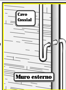
FIGURA 5: Fissaggio del cavo
