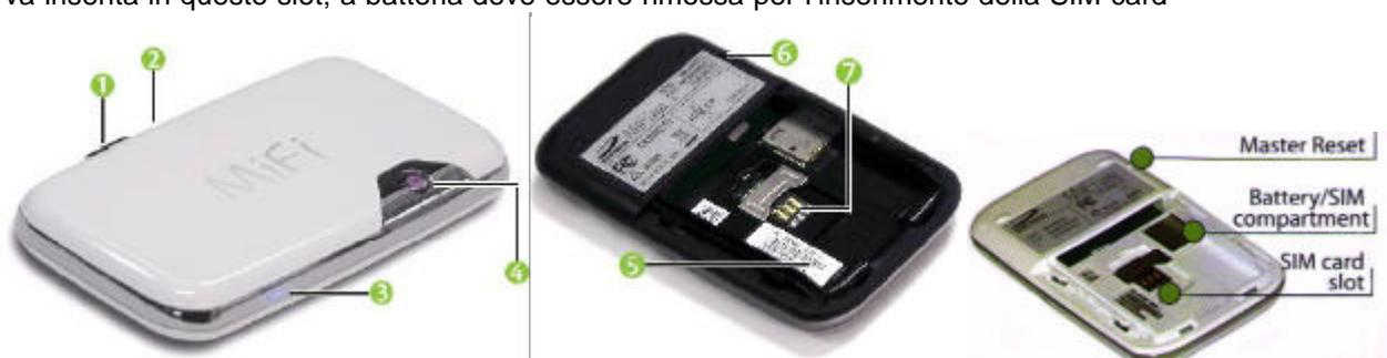
**1) Porta microUSB:** A questa porta si possono collegare il cavetto con connettore microUSB dell'alimentatore e del kit di alimentazione 12VDC (opzionale, non fornito con la confezione standard).
